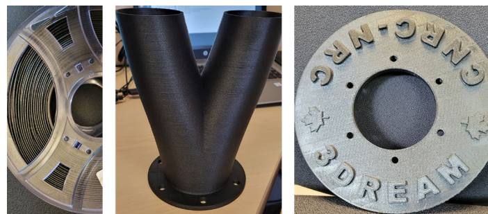
↳ Légende : à l'aide de filaments faits de composites thermoplastiques optimisés et la technologie FFF optimisée dans le groupe R-D industriel 3DREAM, il est possible de créer des pièces imprimées en 3D pour le transport terrestre et aérien. Source : Crédit Dr Mihaela Mihai, Centre de recherche sur l'automobile et le transport de surface du Conseil national de recherches du Canada
